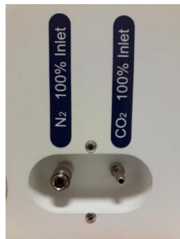
Obrázok 11.1 Prívody plynu na zadnej strane zariadenia Mini MIRI® Dry a Mini MIRI® Humidity multiroom IVF
