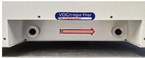
Obrázok 12.1 Prietoková šípka na inkubátore Mini MIRI® Dry multiroom IVF
