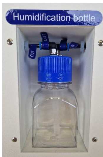
Obrázok 22.1 Pripojenie hadičiek na zvlhčovacej fľaši a viackomorovom inkubátore IVF Mini MIRI® Humidity
