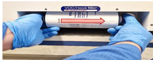
Obrázok 12.2 Postup vkladania a vyberania filtra VOC/HEPA
