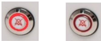
Obrázok 15.1 Tlačidlo alarmu, ktoré indikuje stav alarmu
